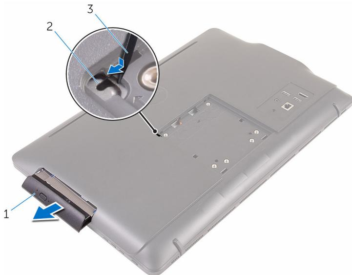
1 Ensamblaje de la unidad óptica
